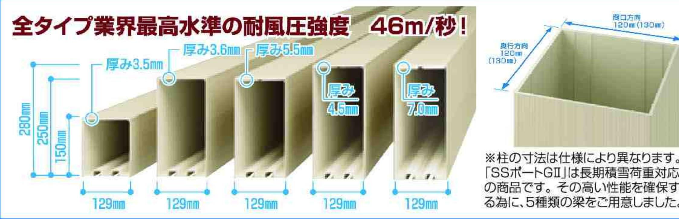
間口方向と奥行方向を120mm(130mm)の同寸法に設定。これにより、従来の柱よりも強度が高まり、特に奥行方向に対する強度が約1.8倍に高まりました。優れた耐荷重性能のみならず、ゆれに対する強度も十分に確保しています。
